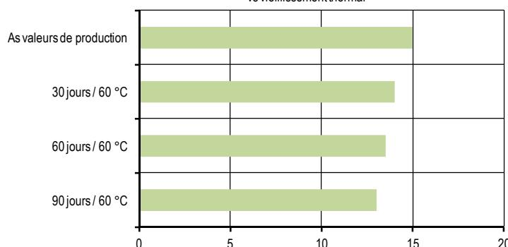
Les tests ont été effectués à 20 °C sur des joints d'acier à acier, qui avaient été vieillis à 60 °C.
