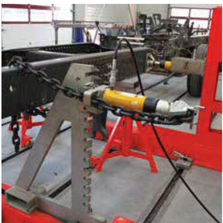
Richten van verbuigingen - dwars vervorming Redressage de déformations - transversales
