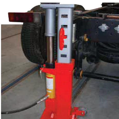
Richten van verbuigingen - verticaal en getorst Redressage de déformations - verticales et vrillages
